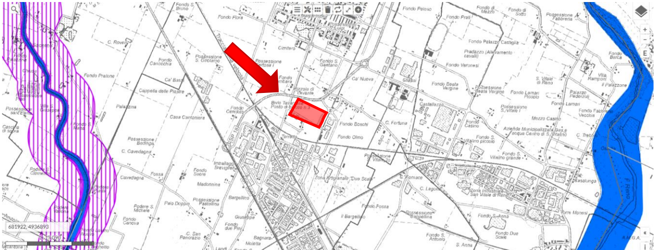
Figura 2 – Estratto dalla Carta di Area Vasta del rischio idraulico del PTM, nella quale emerge che l'area di intervento (in rosso) è esterna all'area ad elevata probabilità di esondazione ed alle fasce di tutela e pertinenza fluviale contenute nel PSAI del fiume Reno e del Torrente Samoggia..
