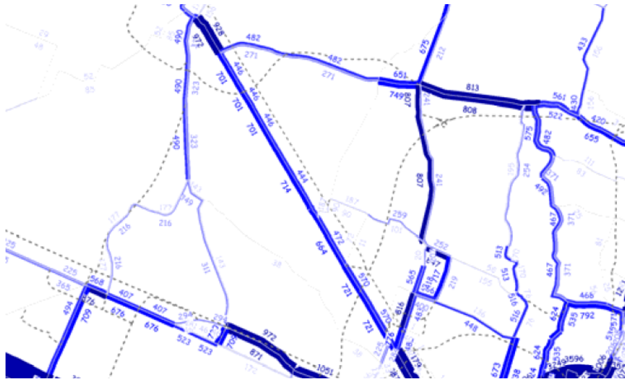
Figura – Flussogramma ora di punta del mattino (PSC Terre d’Acqua – quadro conoscitivo).
